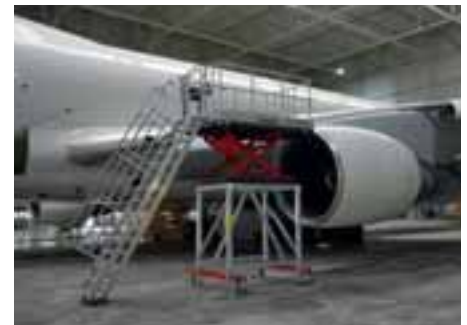
Hydraulisch höhenverstellbare Wartungsbühne
