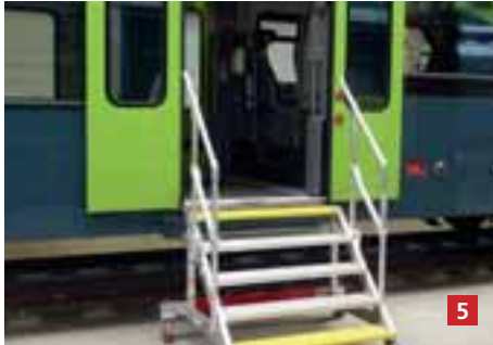
5. Mobile Einstiegshilfen mit Gummi – Anfahrtschutz, 10 Stück als sicherer Zustieg in die Züge, an jeder beliebigen Position in der Werkstatt einsetzbar
