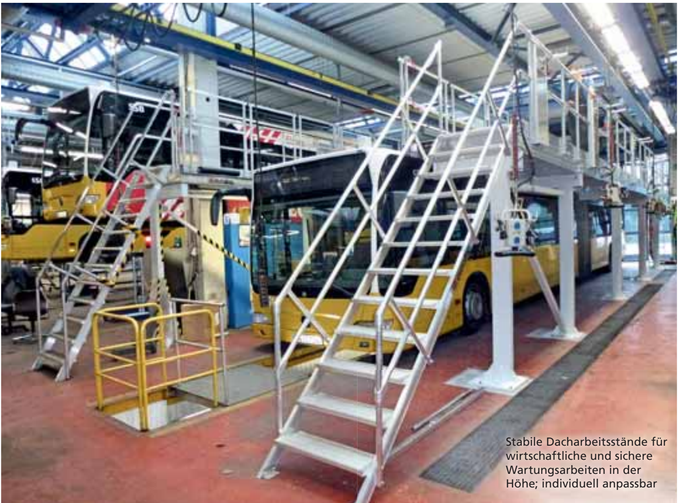
Schnell und garantiert sicher: Wartungsbühne mit Zentralfeststellung
