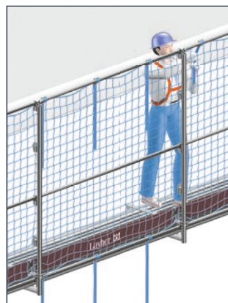
Bild 13 Befestigung des Seitenschutznetzes am oberen Blitz Geländer
