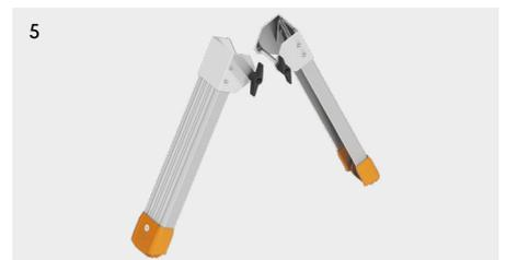
Der Layher Combigrip-Leiternfuß ermöglicht die einfache nachträgliche Montage einer Leitertraverse. Die Traverse wird einfach in die dafür vorgesehene Aussparung des Fußes eingesetzt und mit einer Sechskantschraube fest mit den Holmenden verschraubt.
