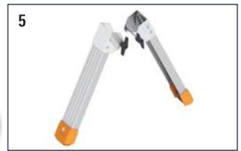
Der Layher Combigrig-Leiternfuß besteht aus einem 2-Komponenten-Kunststoff. Einem harten Innenteil (orange) für einen sicheren Halt im Holm und einem weichen, auf jedem Belag rutschfesten Außenbelag (schwarz). Dies ermöglicht:
