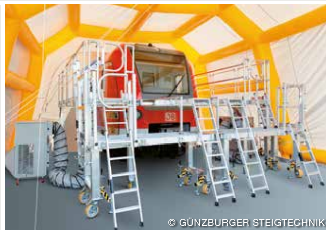
Frontarbeitsbühne im Einsatz bei der DB Fahrzeuginstandhaltung GmbH / Platform for working at the front at DB Fahrzeuginstandhaltung GmbH
