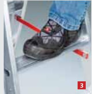
Die PREMIUM-Line und WORK-Line Stufenleitern (3) haben hochfest verbördelte Stufen-/Holmverbindungen mit 80 mm tiefen, profilierten Stufen für einen sicheren Aufstieg und ermüdungsfreien Stand, der Stufenabstand beträgt 250 mm.
