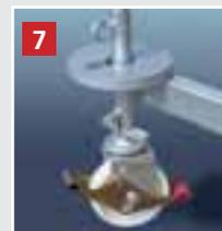
**Ballastgewichte** am Fahrbalken oder direkt am Gerüststrahlen bieten zusätzliche Sicherheit.
