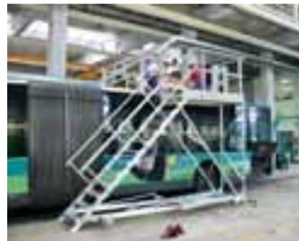
Schnell und garantiert sicher: Wartungsbühne mit Zentralfeststellung
