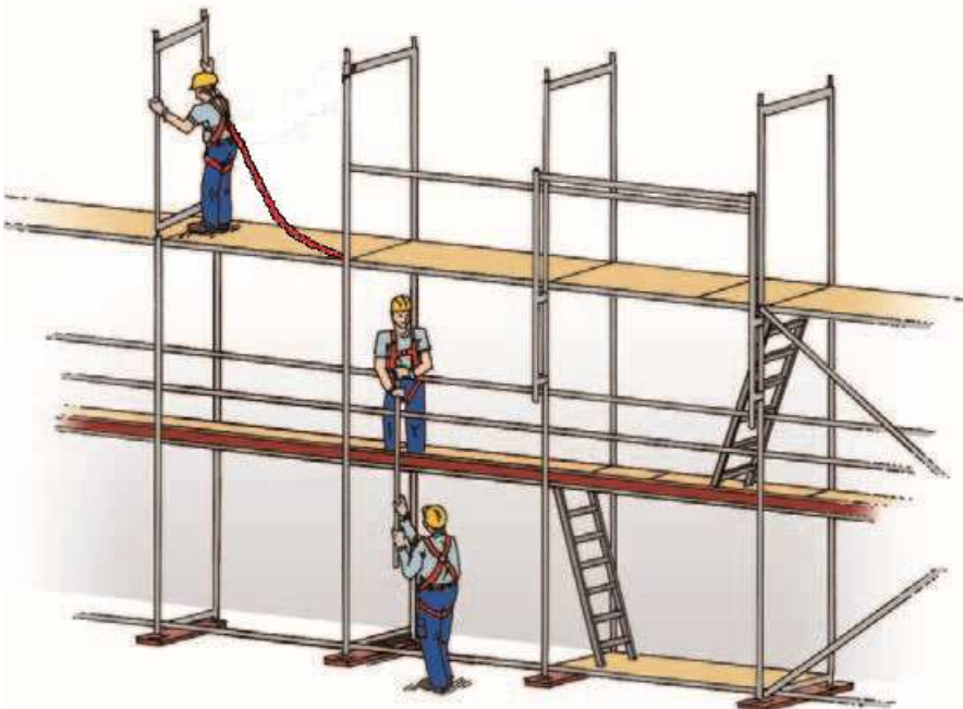
Bild 14: Materialannahme und Gerüstmontage auf der obersten Gerüstlage
