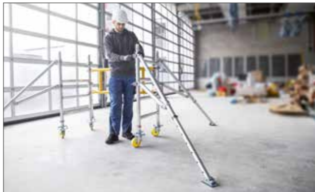
Einfache Montage der Ausleger für einen sicheren Stand
