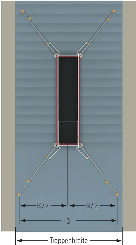
Es handelt sich hierbei um einen Aufbau der beidseitig durch Gerüststützen abgestützt werden kann.
