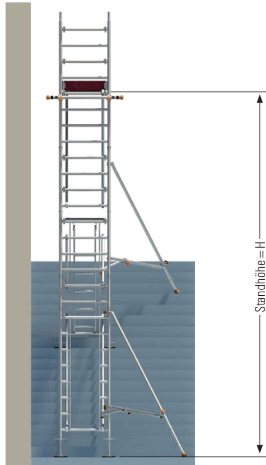
Ab einer Treppenbreite von > 2 m, ist durch das ausreichende Auslegermaß der Gerüststützen, keine Ballastierung erforderlich.
