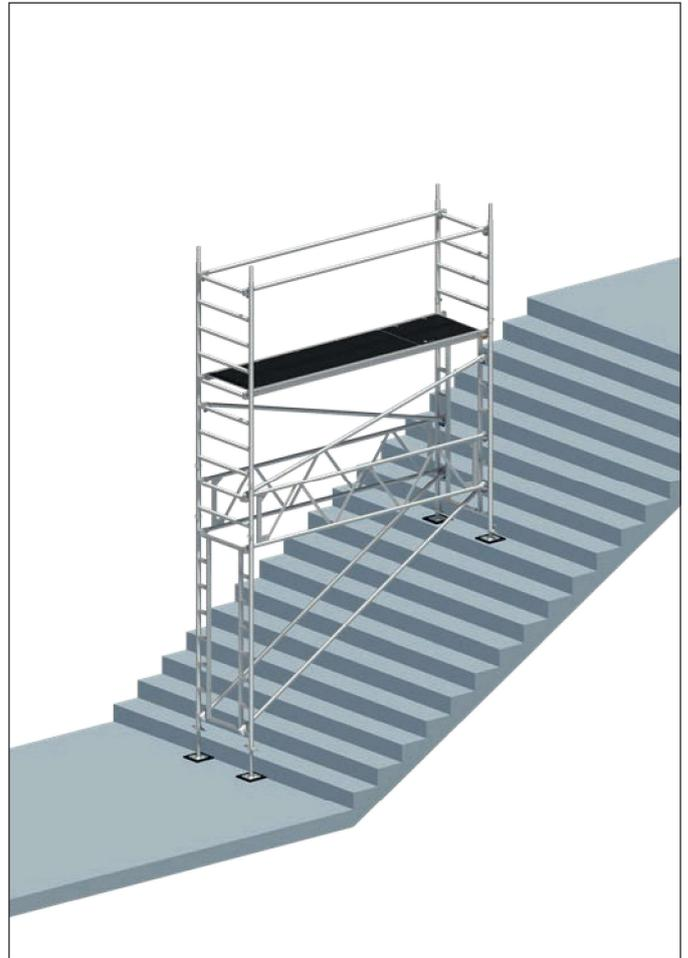
11. Aufschwenken und Aufstecken der positionierten Standleiter 1 m auf die in der Durchgangs-Standleiter **1** dafür vorgesehenen Rohrverbinder.
