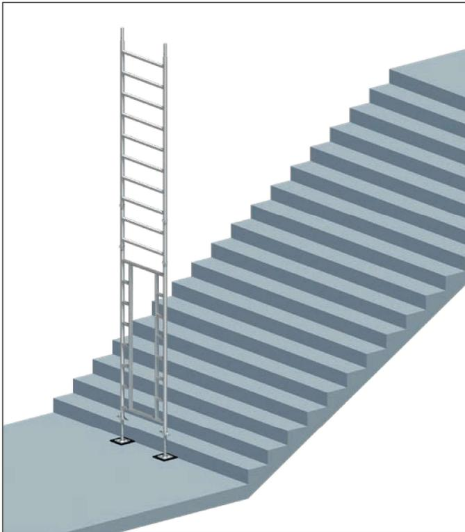
1. Als Vormontage erfolgt das Zusammenstecken einer Standleiter 0,5m **2** und einer Standleiter 2m, welche dann auf die Durchgangs-Standleiter **1** aufgesteckt werden.
