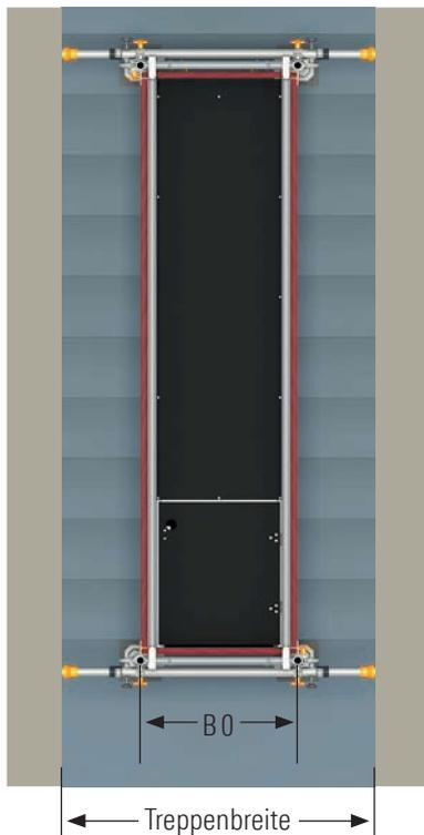
Es handelt sich hierbei um einen Aufbau der keine Abstützung durch Gerüststützen vorsieht bzw. wenn diese nicht wirkend eingesetzt werden können.
