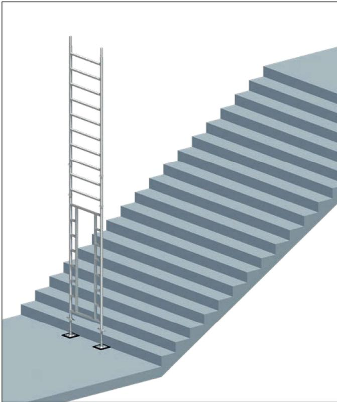
1. Als Vormontage erfolgt das Zusammenstecken einer Standleiter 0,5m **2** und einer Standleiter 2m welche dann auf die Durchgangs-Standleiter **1** aufgesteckt werden.
