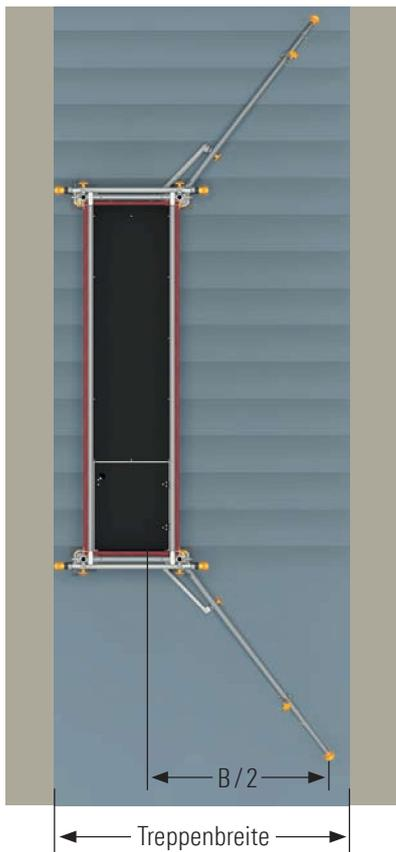
Es handelt sich hierbei um einen Aufbau der einseitig an eine Wand und auf der gegenüberliegenden Seite durch Gerüststützen abgestützt werden kann.
