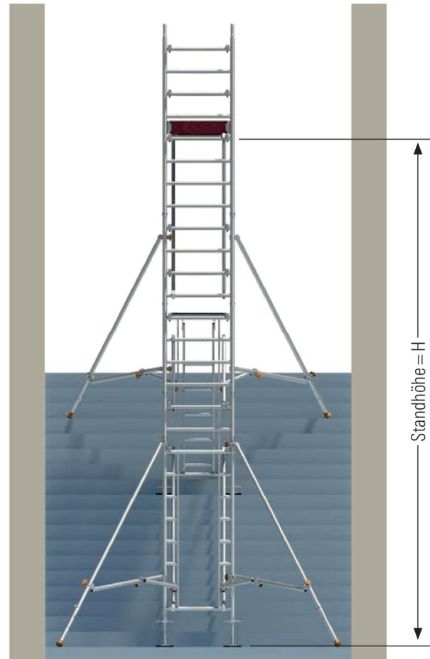
Ab einer Treppenbreite von  $>2$  m ist durch das ausreichende Auslegermaß der Gerüststützen, keine Ballastierung erforderlich.
