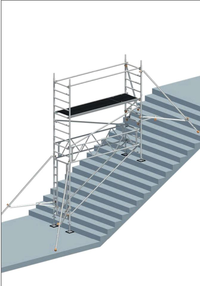
15. Anbau der Gerüststützen (s. S. 20, Kapitel 7. Gerüststützen-Anbau).
