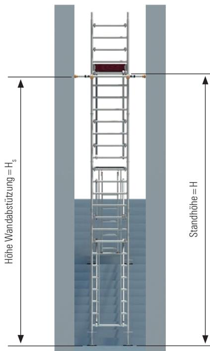
Zur Positionierung in der Höhe darf das Verhältnis zwischen der Standhöhe H und der Höhe der Wandabstützung  $H_s$  den Wert 1,5 nicht unterschreiten.
