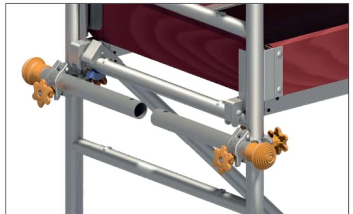
Für die Anlage an der Wand sind die Gerüstkupplungen wieder so weit zu lösen bis ein Verschieben und Positionieren des dafür vorgesehenen Gummifußes an der Wand erreicht wird, danach sind die Gerüstkupplungen wieder fest anzuziehen.
