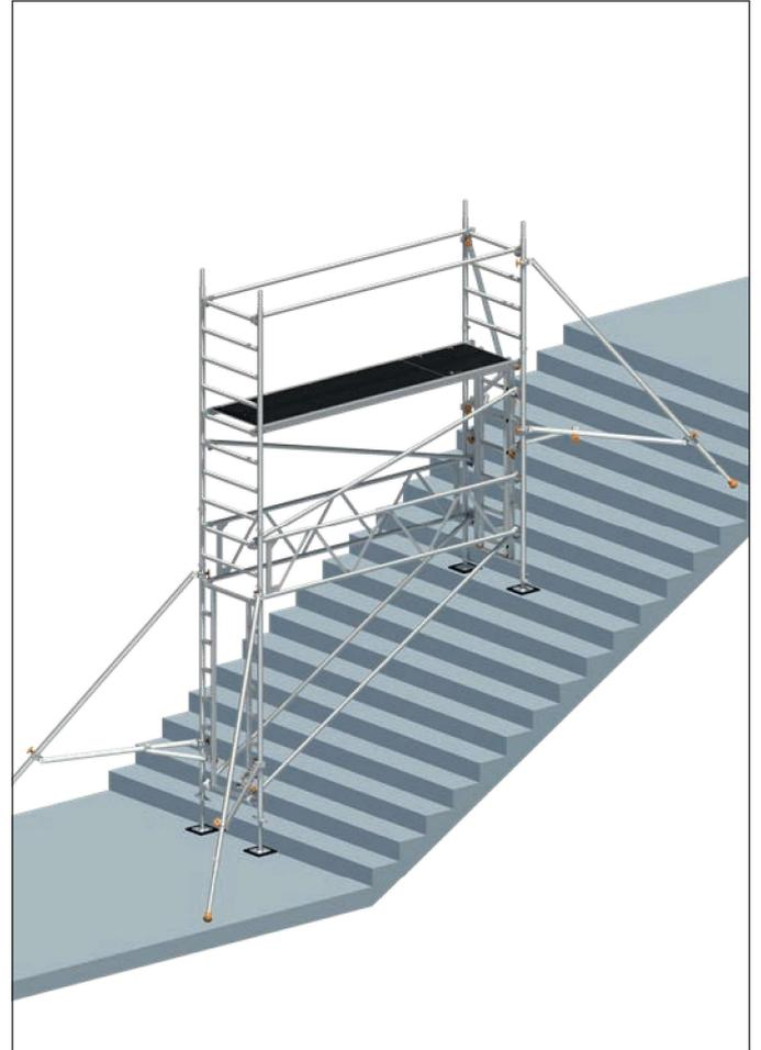
16. Anbau der Gerüststützen (s. S. 20, Kapitel 7. Gerüststützen-Anbau)
