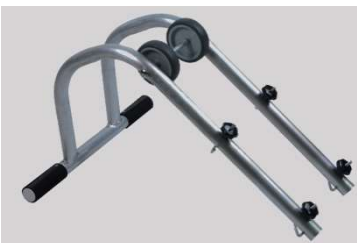
LZ003020 Firstüberwurfbügel Alu für Sprossenleitern, Sprossenabstand 28cm
