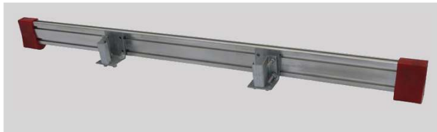
LZ7300-4 Für ein- und mehrteilige Leitern ab 2018 lt. DIN EN131 1- 4 ab < 3m Leiternlänge erforderlich Quertraversen Nachrüstset 120cm Passend für alle Leitern mit Holmhöhe 60-118mm und Holmbreite 20-25mm
