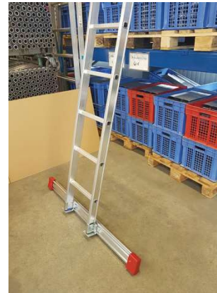
LZ7300-4 Für ein- und mehrteilige Leitern ab 2018 lt. DIN EN131 1- 4 ab < 3m Leiternlänge erforderlich Quertraversen Nachrüstset 120cm Passend für alle Leitern mit Holmhöhe 60-118mm und Holmbreite 20-25mm
