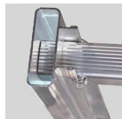
Formschlüssige, einzeln in den Holm eingelassene, beidseitig 2-fach verschweißte Sprossen-Holm-Verbindung
