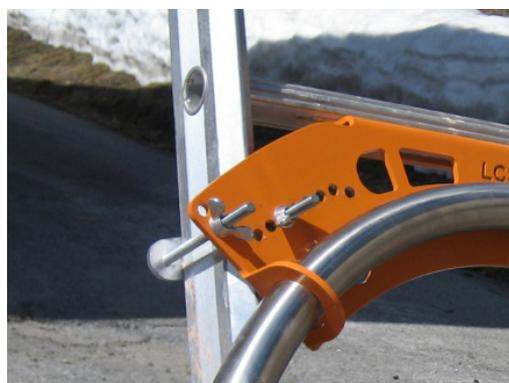
Die zwei **Befestigungsschrauben**, welche auf jeder Seite den Leiterholm mit dem Leiteradapter verbinden, **parallel** durch den Leiteradapter führen, dies ist gegeben wenn dazwischen jeweils **drei Löcher frei bleiben**.
